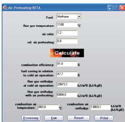
Bild 6: Wirkungsgradsteigerung und Verbrennungs-Enthalpie bei Lambda 1,2 (Quelle: www.FlammeConsulting.de) Fig. 6: Increase in efficiency and combustion enthalpy at \lambda = 1.2 (source: www.FlammeConsulting.de)
